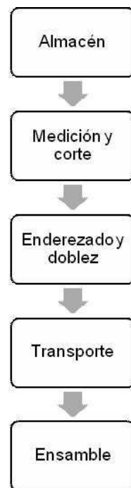
Diagrama de flujo del proceso de trabajo de armado del emparrillado Obra de construcción, ciudad de México, 2017
